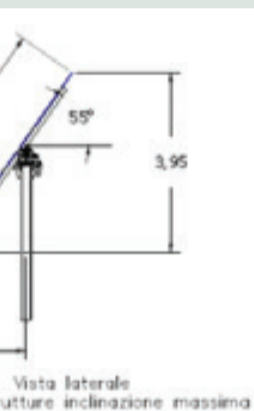
3. SCHEMA CHE ILLUSTRRA LA DISTANZA TRA I MODULI E LA LORO INCLINAZIONE
