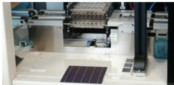
ALCUNI SCATTI DELLA LINEA DEMO DOVE VENGONO TESTATE LE TECNOLOGIE IMPLEMENTATE NEL LABORATORIO DI RICERCA E SVILUPPO. NELLA SEQUENZA ALCUNI DETTAGLI DEL PROGETTO DI SERIGRAFIA DELLE CELLE SOLARI
