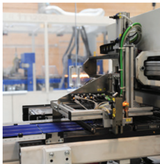
LE LINEE PRODUTTIVE REALIZZANO OGNI GIORNO, SU TRE TURNI, 1.600 MODULI FOTOVOLTAICI CON TECNOLOGIA PERC E CELLE A 5 BUS BAR
