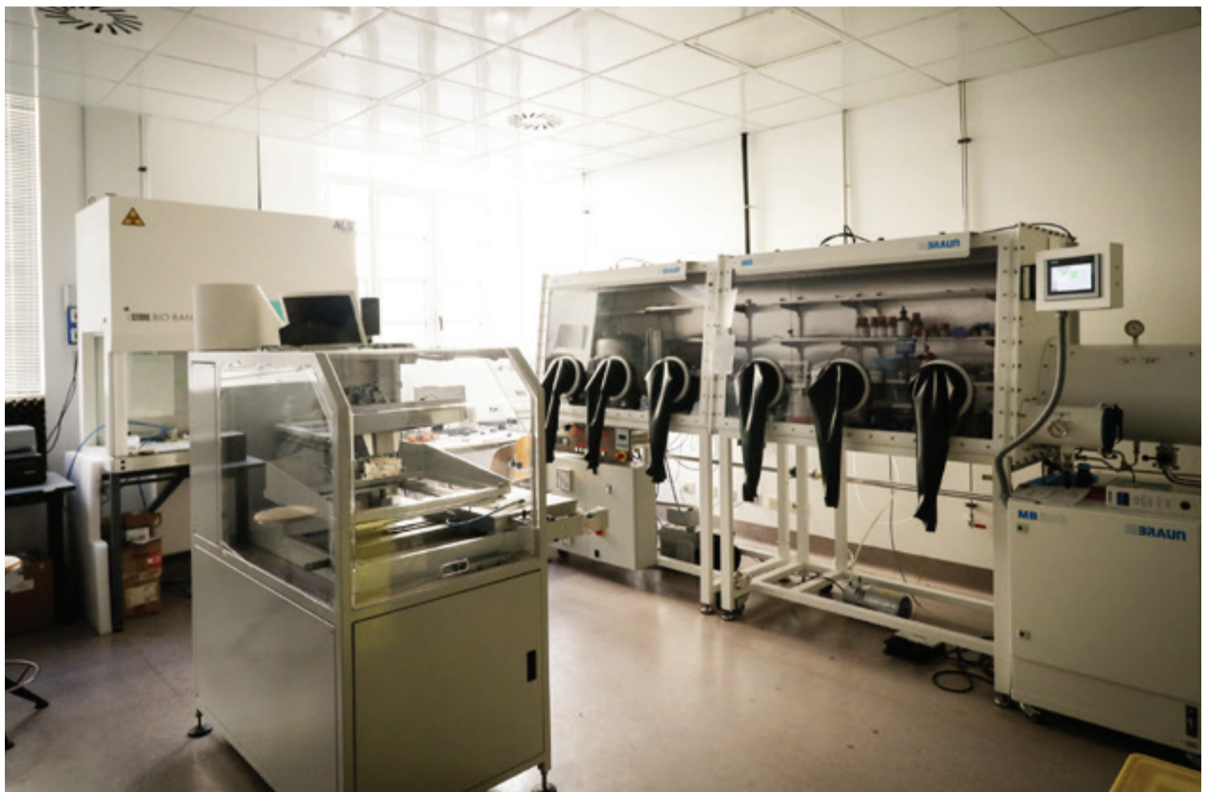
LA GLOVE-BOX, DOTATA DI SPIN COATER ED EVAPORATORE PER PREPARARE DISPOSITIVI FOTOVOLTAICI IN ATMOSFERA INERTE È UNA DELLE NUMEROSE ATTREZZATURE ALL'AVANGUARDIA DI CUI DISPONE IL CENTRO MIB SOLAR DEL DIPARTIMENTO DI SCIENZA DEI MATERIALI DELL'UNIVERSITÀ DI MILANO BICOCCA
