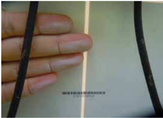
UN ESEMPIO DI BACKSHEET CRACK, CON PERDITA DI COLORE BIANCO
