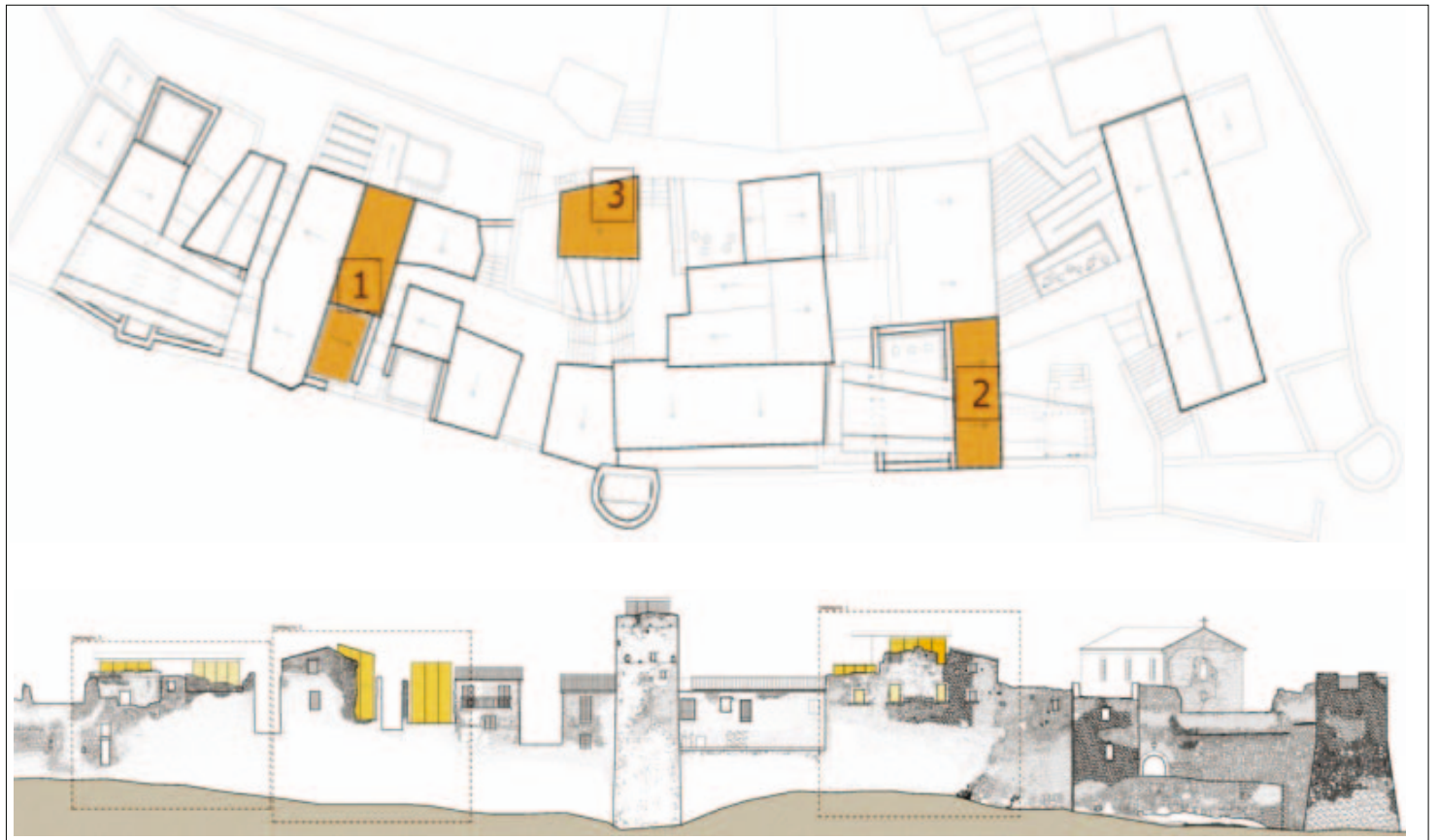
Figura 3. Il recupero del borgo di Vicalvi, in Abruzzo. In evidenza i nuovi blocchi funzionali che ospitano sistemi di sfruttamento dell'energia solare
