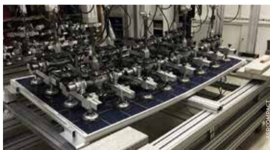
SIMULAZIONE DEI CARICHI DI PRESSIONE: UN TEST SUL NOSTRO SISTEMA COMPACTFLAT S SUD
