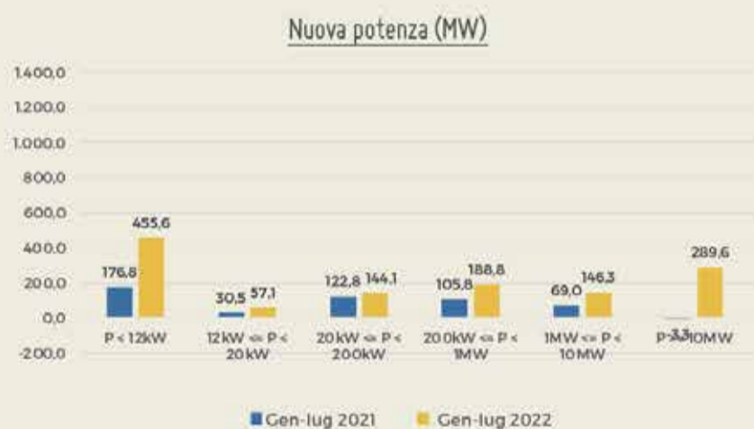
Nuova potenza (MW) e numero impianti FV installati in Italia per taglia – Gen-lug 2022 vs Gen-lug 2021
