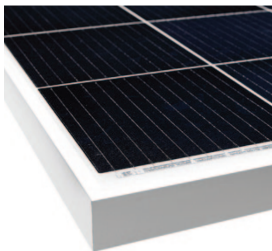
A SINISTRA UN ESEMPIO DI MODULO POLICRISTALLINO CON CELLE A 12 RIBBON. IL DESIGN CON I 12 FILI RIDUCE LE ZONE OMBREGGiate SULLA CELLA RISPETTO AI BUS BAR NORMALI, E AUMENTA COSÌ L'ASSORBIMENTO DELLA LUCE. A DESTRA UN ESEMPIO DI PANNELLO POLICRISTALLINO CON CELLE A 4 BUS BAR STANDARD
